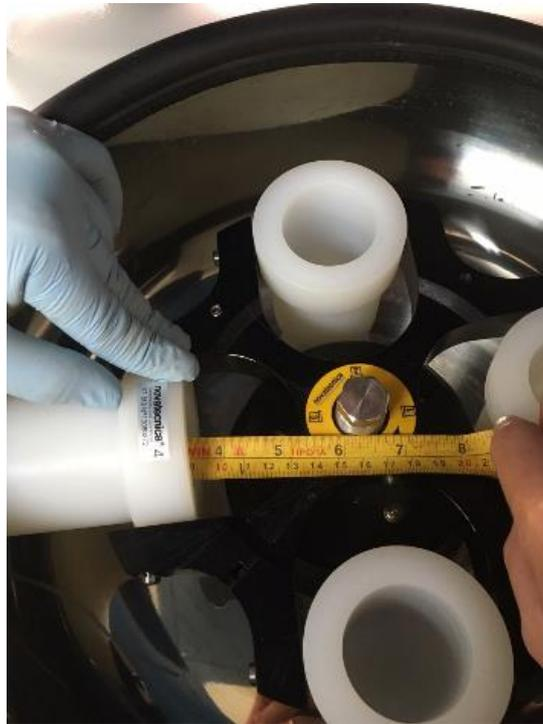
**Figura 1: Medição do raio do rotor da centrífuga para cálculo do número de rotações por minuto**
